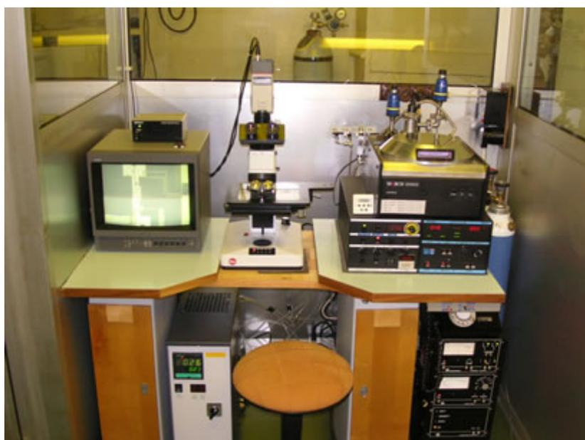
Рис. 16. Установка высокочастотного плазмохимического травления March Yupiter II фирмы «March Instruments Incorporated» с рабочей частотой генератора 13.56 МГц; оборудована четырьмя газовыми вводами.
