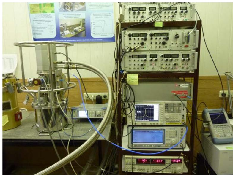
Рис. 19. Фотография установки для исследования сверхпроводниковых интегральных приемных структур в криогенной системе замкнутого цикла.
