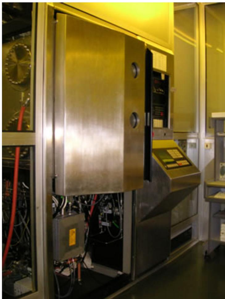
Рис. 15. Сверхвысоковакуумная установка магнетронного напыления L-560 UV фирмы "Leybold". Оборудована двумя DC- магнетронами для напыления металлических слоев и одним RF- магнетроном для напыления металлических и диэлектрических слоев с рабочей частотой генератора 13.56 МГц и пушкой для ионного травления.
