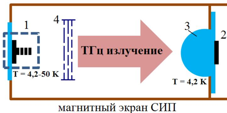
Рис. 1. Схема эксперимента по измерению спектра излучения BSCCO-генератора при помощи сверхпроводящего интегрального спектрометра (1 - BSCCO-генератор, 2 – микросхема приемника, 3 – линза, 4- тепловой фильтр).
