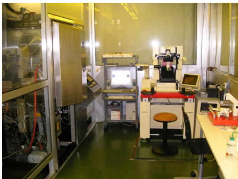
Рис. 14. Чистая комнаты класса 1000 с рабочими зонами класса 100 и оборудован системами вентиляции, очистки и кондиционирования воздуха и системами деионизации воды. Слева установка магнетронного напыления L-560 UV фирмы «Leybold», в центре - установка оптической фотолитографии MA-150 «Karl Suss».
