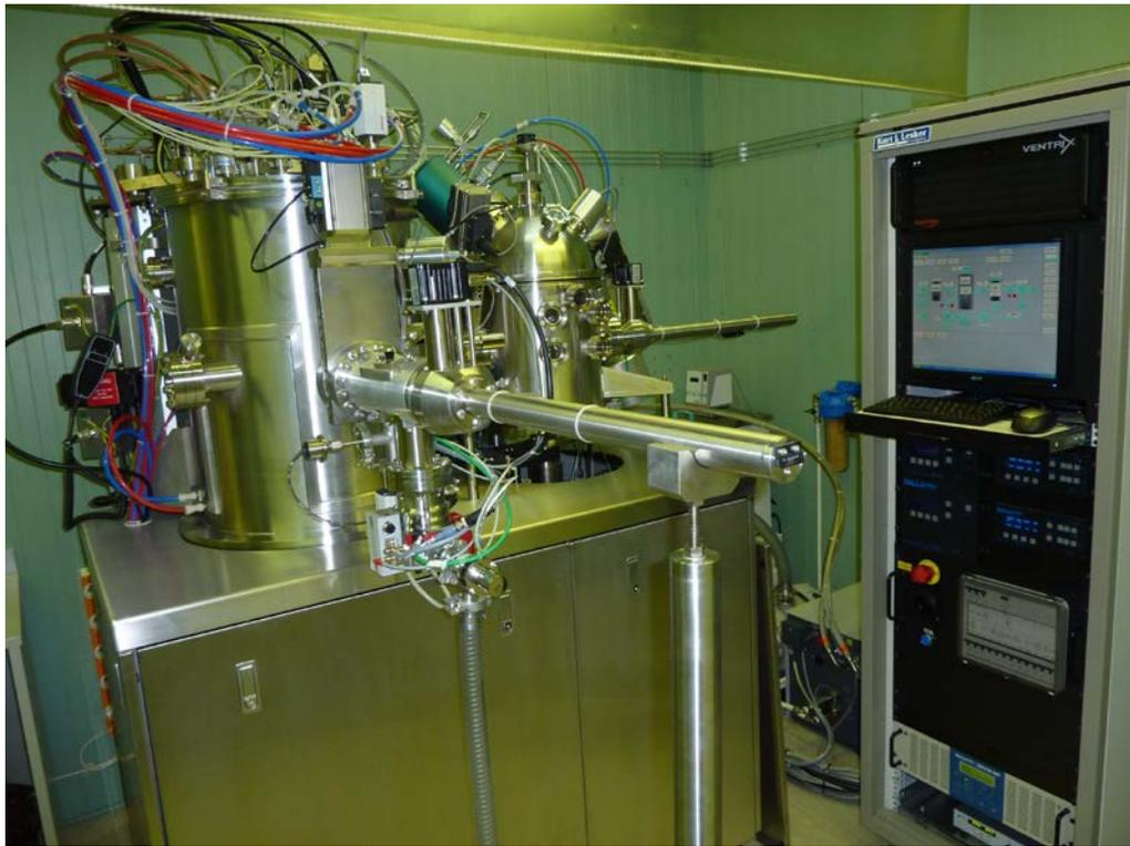
Рис. 18. Сверхвысоковакуумная установка магнетронного распыления кластерного типа модель KJLC CMS IN-LINE SPUTTER DEPOSITION SYSTEM фирмы Курт-Лескер (США), после ее запуска в ИРЭ им. В.А. Котельникова РАН.
