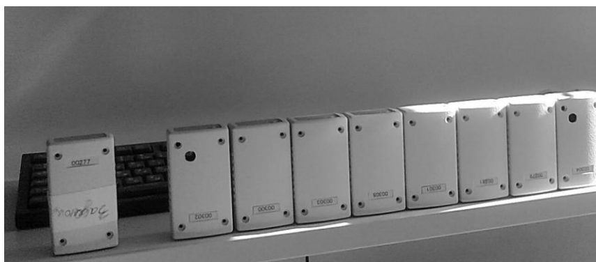
Рис. 6.33. Экспериментальный ансамбль с 8 передатчиками, слева – задающий передатчик 0
