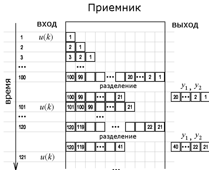
Рис. 4.18. Алгоритм разделения хаотических сигналов в режиме реального времени
