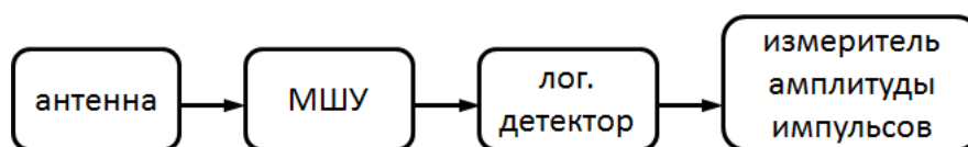
Рис. 5.26. Блок-схема приемника хаотических радиопulses
