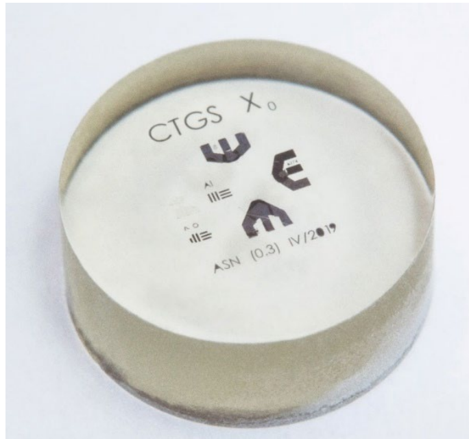
Рис. 4.24. Один из исследуемых образцов: три композитных ОАВ-резонатора, напылённые на кристалл СТГС X-среза.
