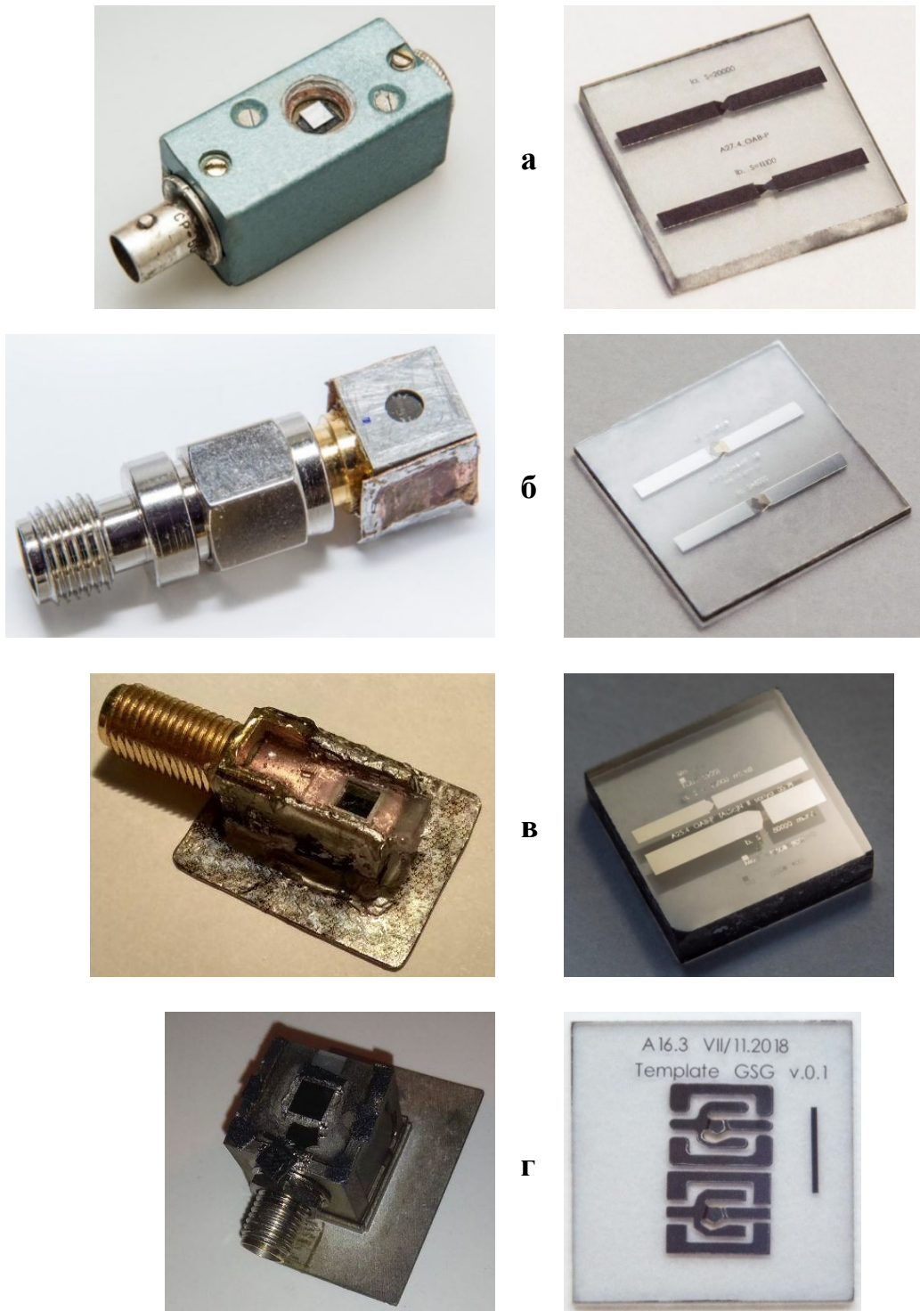
Рис. 2.4. Прототипы корпусированных сенсоров и композитные ОАВ-резонаторы, использованные при их создании.
