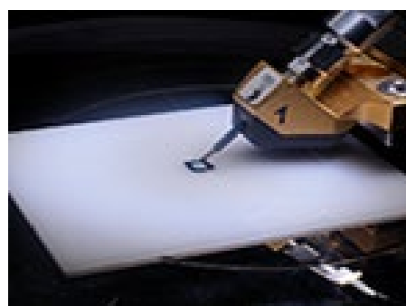
Рис. 2.7. Образец с прижатым к нему зондом.
