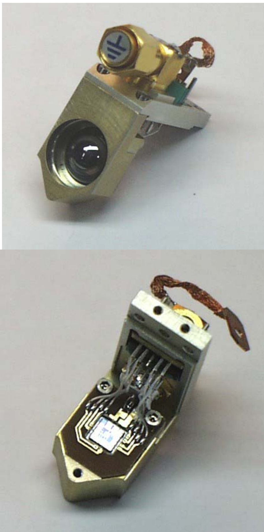
рис. 1.13. Модуль интегрального приемника с кремниевой линзой [75].
