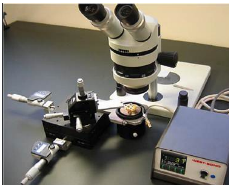
рис. 3.39. Фотография варианта исполнения установки для прецизионного монтажа чипов на линзу. Установка разработана и фотография сделана Уваровым А.В [А14].
