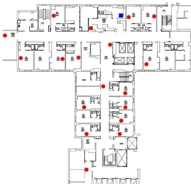
Рис. 1.5. Схема расположения ретрансляторов (обозначены кругом) и базовой станции (обозначена квадратом) в больнице при прохождении клинических испытаний.
