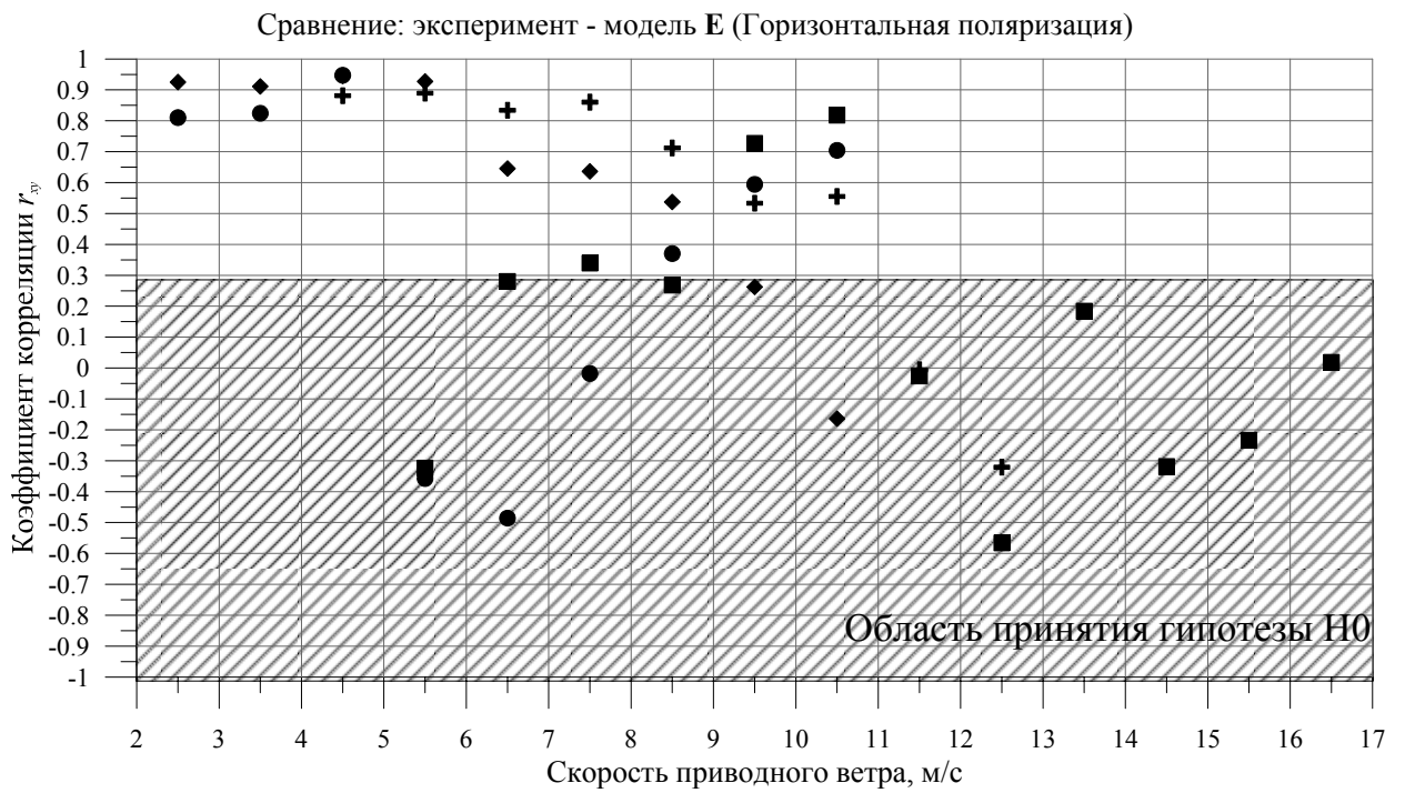
Рисунок П1.2 — Результаты корреляционного анализа экспериментальных данных и модели E
