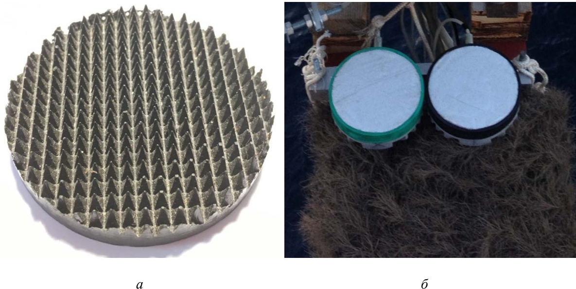
Рисунок 2.6. а) Радиопоглощающий материал для частоты \sim 37 ГГц; б) Расположение согласованных нагрузок в эксперименте (зеленая — 51^\circ\text{C} , черная — 13^\circ\text{C} ).
